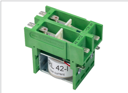
Relais RL 42-I, bis 6.000 V AC, 2 Wechsler, low current
